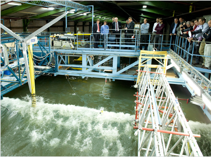
FIGUUR 3 Een model van een windturbine in één van de waterbassins van het MARIN.
