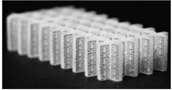
Metamateriaal bestaat uit een structuur van vele split-ring resonatoren.
