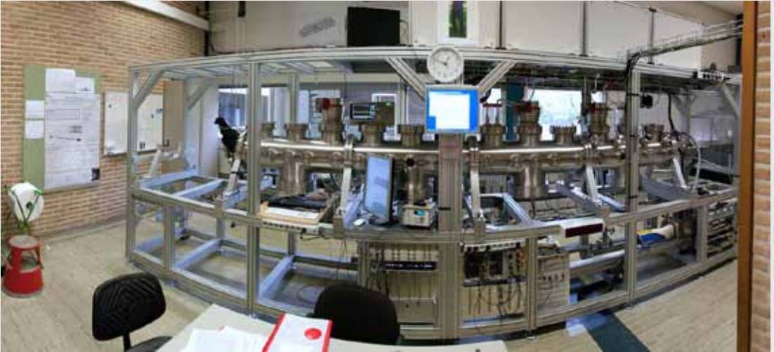
FIGUUR 2 Een foto van de 4 meter lange opstelling in het lab. Rechts worden de moleculen in de bronkamer gemaakt, waarna ze naar links vliegen en door de afremmer worden afgeremd. Door de gebruikte lens lijkt de afremmer gebogen, in werkelijkheid is hij kaarsrecht.
