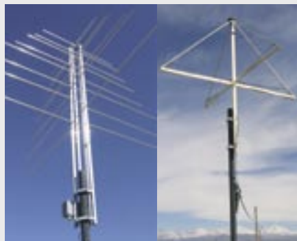
FIGUUR 3 Links: een LPDA-antenne. Rechts: een LOFAR-antenne.
