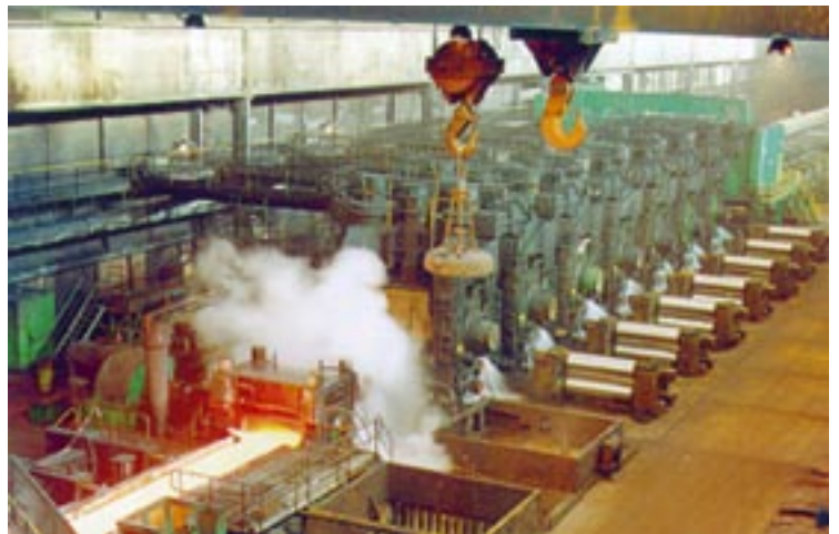
Warmband eindwalssectie met roodgloeiende band staal, het stoom van de oxideverwijdering en zeven walsstands. Er staan ook zeven nieuwe stellen walsen gereed om de gebruikte te vervangen.
